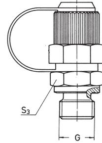
Einschraubgewinde: Whitworth-Gewinde, zylindrisch - Einschraubzapfen mit Dichtung
