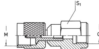
**Gerade Verschraubung mit Schraubkupplung M16**
