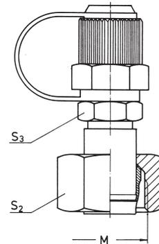
**Hochdruck-Meßschläuche DN 2 für Schraubkupplung M16**
