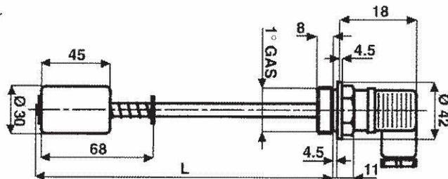
**Thermostat – Bimetall – Einschraubbar**
