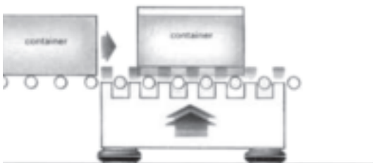
Schwingungsförderung des Formsandes in Gießereien
